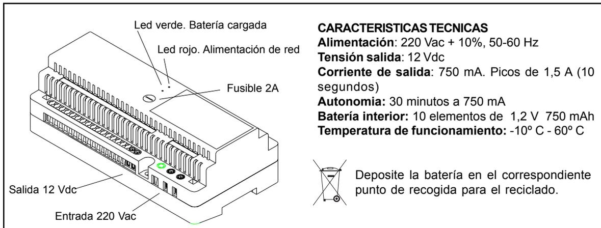
**CARACTERISTICAS TECNICAS****Alimentación:** 220 Vac + 10%, 50-60 Hz**Tensión salida:** 12 Vdc**Corriente de salida:** 750 mA. Picos de 1,5 A (10 segundos)**Autonomía:** 30 minutos a 750 mA**Batería interior:** 10 elementos de 1,2 V 750 mAh**Temperatura de funcionamiento:** -10° C - 60° C
